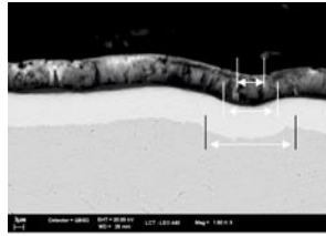
Bild 4: Bei einer Gesamtschichtdicke von etwa 20 µm wird der Untergrund eben und es bildet sich eine äußerst glatte Oberfläche aus
